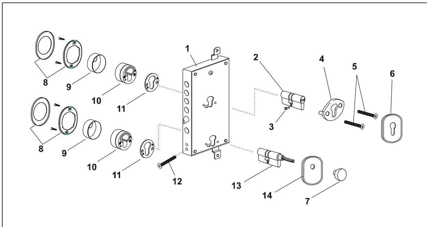
Il disegno indica in primo piano la sequenza di fissaggio di un cilindro chiave-chiave e un cilindro chiave-pomolo alla serratura multi cilindro.
