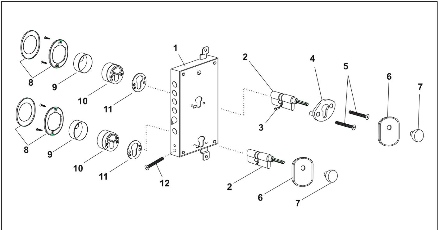
Il disegno indica in primo piano la sequenza di fissaggio di due cilindri (chiave-pomolo) alla serratura multi cilindro.
