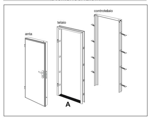
Il sistema di tenuta prevede una buona muratura del **controtelaio** e l'assemblaggio corretto del **telaio** al controtelaio. Prima dell'assemblaggio al controtelaio, il **telaio** va unito a pavimento con una soglia (**A**) formando la continuità sui quattro lati e quindi una battuta integrale per l'anta.
