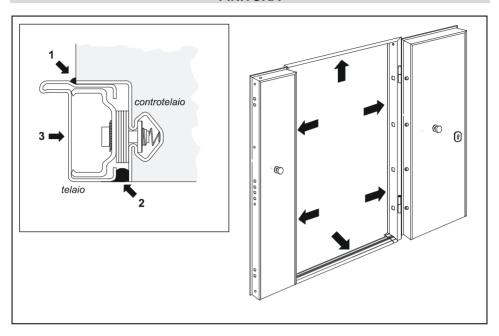
Una operazione importante è quella di un controllo della posa del silicone.
