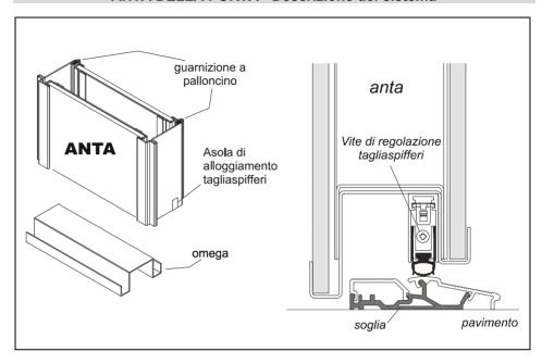
L'**omega** è un componente standard delle porte, sostiene i rivestimenti e alloggia il tagliaspifferi (nella normale configurazione di serie).
