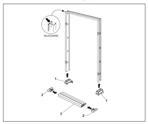
I "tappi spessore" (1) vanno inseriti all'interno dei due montanti del telaio. Inserire i "terminali soglia" (2) nella soglia (3).
