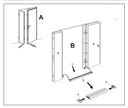
Assemblata l'anta sul telaio (A), provata l'apertura e la chiusura della porta, ultimate le eventuali regolazioni - come descritto nel manuale di posa della porta - occorre sigillare con silicone la soglia a pavimento.
